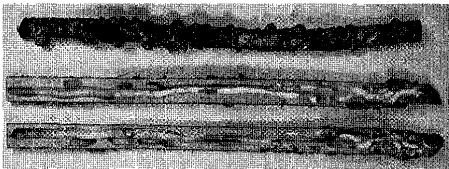
Onbehandeld rijshout, sterk aangetast door de paalworm na één seizoen in zeewater
